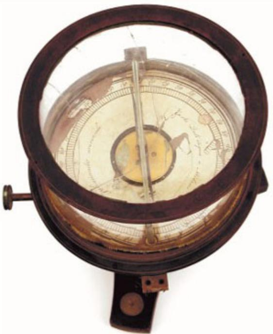
Strumento atto a misurare le correnti galvaniche o elettriche, costruito da Carlo Dell'Acqua è costituito da una teca a forma cilindrica di vetro, collocato su un supporto con stelo e treppiede in legno. Alla base tre viti calanti in ottone consentano il posizionamento rigorosamente orizzontale dello strumento. All'interno della teca vi è un ago magnetizzato che può ruotare orizzontalmente su un perno. Il cerchio di base è diviso in quattro quadranti, ciascuno graduato da 0 a 90 gradi.
