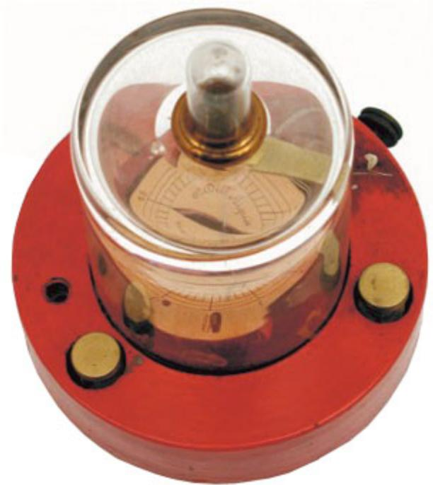
Nobili ideò questo tipico strumento da laboratorio nel 1828: in esso le parti costruttive del grande galvanometro, furono ridotte agli elementi essenziali. Il numero di spire e il diametro del filo della bobina variavano a seconda dell'uso per il quale il galvanometro era stato ideato.
